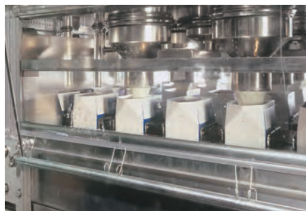
Положительное давление в цехах розлива помогает поддержать надлежащий уровень гигиены процессов розлива и дозировки в пищевой промышленности и фармацевтике
