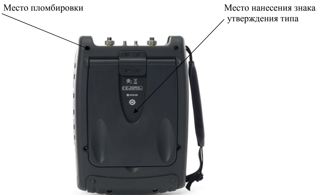
Рисунок 2 - Схема пломбировки от несанкционированного доступа, обозначение места нанесения знака утверждения типа
