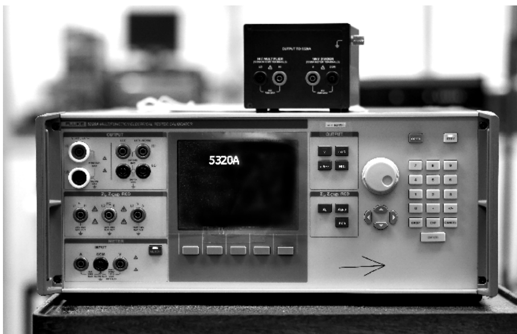
Рисунок 1 - Внешний вид калибратора тестеров многофункционального Fluke 5320A
