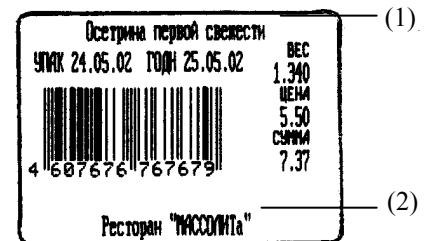
Рис. 10. Пример печати этикетки формата 58. Этикетка размером 40 x 30 мм, без препринта. Это минимально возможный размер этикетки, в полях “наименование товара” (1) и “магазин” (2) печатается только первая строка мелким шрифтом.
