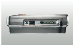
Разъем для подключения Мини-USB кабеля или SD-карты
