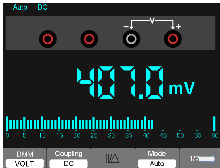
Рисунок 7-6 Измерение напряжения постоянного тока
