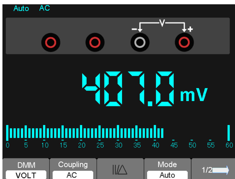
Рисунок 7-7 Измерение напряжения переменного тока
