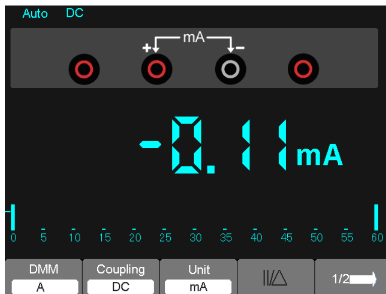
Рисунок 7-8 Измерение тока для силы тока менее 600 мА
