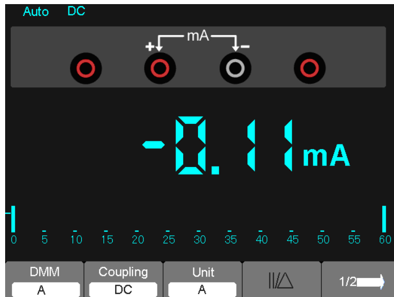
Рисунок 7-9 Измерение тока для силы тока 10A
