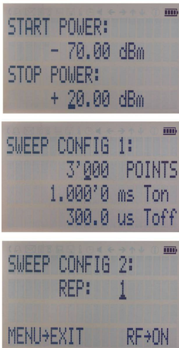
Рисунок 4-с. Экраны настройки свипирования мощности
